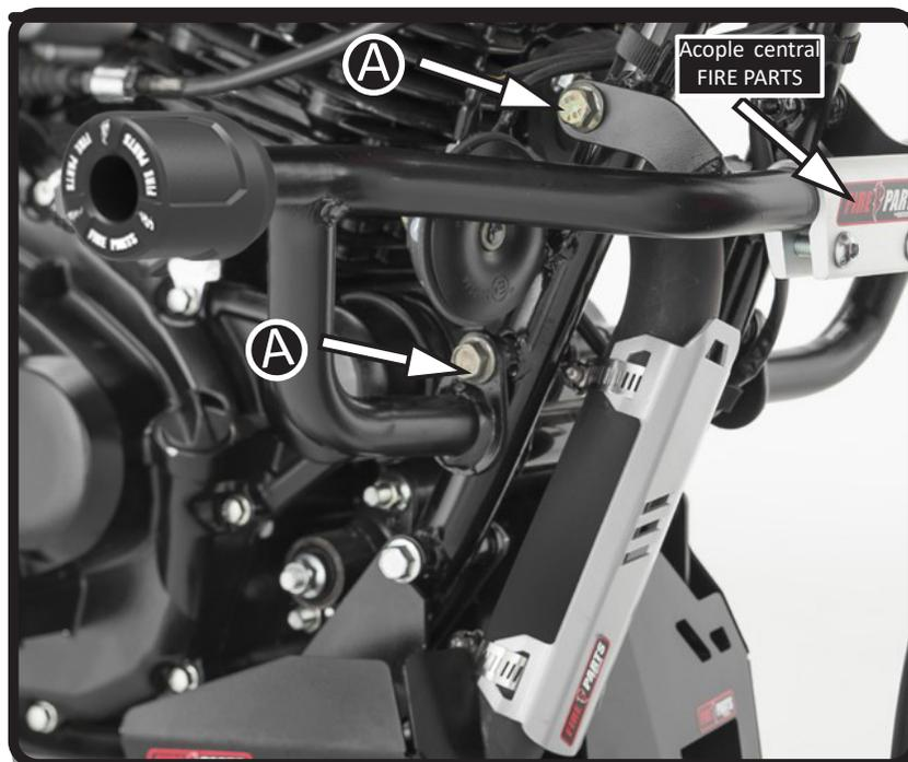
Retire las barras protectoras originales de la moto para instalar los Sliders **FIRE PARTS**. Utilice los tornillos entregados en el Kit TF2 para instalarlos en los puntos marcados con (A) en la imagen. Instale un lado del Slider, monte el acople central AC3 alinee con el otro lado.
