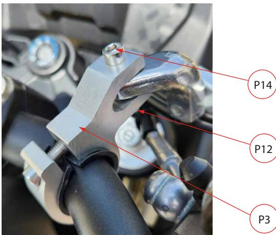
**2** Identifique las partes (P) que se requiere para instar el punto en manubrio de la abrazadera y el alma de aluminio (P2). Este procedimiento es igual para ambos lados Derecho e Izquierdo.
