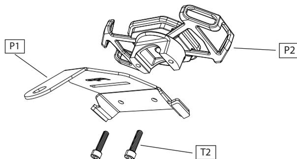
**2** Ubique los puntos de sujeción (A) y (B) en la Tapa superior ubicada en el manubrio. En el punto (A) utilice los insumos (P1)(T1)(B1).
