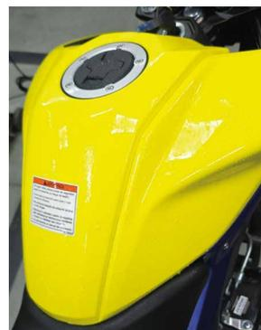
**4** Una vez este correctamente posicionado el adhesivo, Humectar la superficie y usar el asentador FP a 90° para retirar la mezcla entre la superficie y el adhesivo, luego se podrá ir cambiando el ángulo de 90° a un ángulo inferior para facilitar el drenaje de la mezcla hasta que quede completamente adherido y sin burbujas a la superficie.
