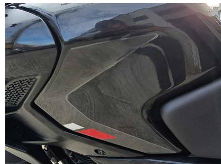
**4** Una vez este correctamente ubicado el adhesivo. Humectar nuevamente y usar el asentador FP a 90° para retirar la mezcla entre la superficie y el adhesivo, luego se podrá ir cambiando el ángulo de 90° a un ángulo inferior para facilitar el drenaje de la mezcla hasta que quede completamente adherido y sin burbujas a la superficie.
