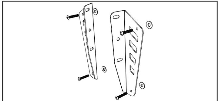
**3** Colocar las platinas superiores usando los tornillos y las tuercas M6 en la posición de tu preferencia como se muestra en el esquema, la posición 1 eleva la cúpula 11cms y la posición 2 eleva 6cms. En ambas posiciones se puedes ajustar el ángulo de la cúpula.
