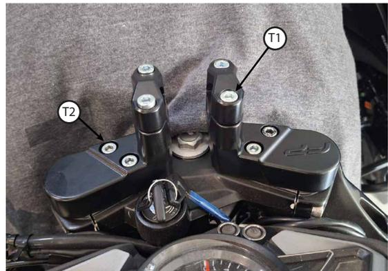
Una vez el manubrio se encuentre en la posición deseada apriete primero los tornillos de la parte trasera por completo y posteriormente los tornillos de la parte delantera.
