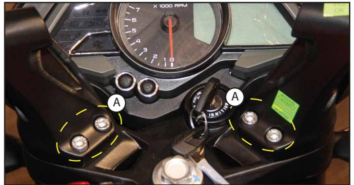
**2** Monte el manubrio Tipo Fatbar (1 1/8") e instale las abrazaderas con los tornillos (T1).
