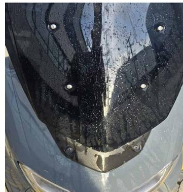
**4** Una vez este correctamente posicionado el adhesivo, Humectar la superficie y usar el asentador FP a 90° para retirar la mezcla entre la superficie y el adhesivo, luego se podrá ir cambiando el ángulo de 90° a un ángulo inferior para facilitar el drenaje de la mezcla hasta que quede completamente adherido y sin burbujas a la superficie.
