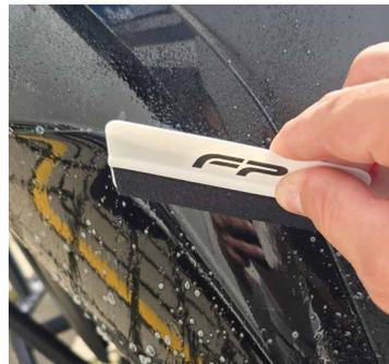
**4** Una vez esté correctamente posicionado el adhesivo, Humectar la superficie y usar el asentador FP a 90° para retirar la mezcla entre la superficie y el adhesivo, luego se podrá ir cambiando el ángulo de 90° a un ángulo inferior para facilitar el drenaje de la mezcla hasta que quede completamente adherido y sin burbujas a la superficie.
