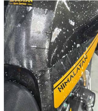
**4** Una vez esté correctamente posicionado el adhesivo, Humectar la superficie y usar el asentador FP a 90° para retirar la mezcla entre la superficie y el adhesivo, luego se podrá ir cambiando el ángulo de 90° a un ángulo inferior para facilitar el drenaje de la mezcla hasta que quede completamente adherido y sin burbujas a la superficie.
