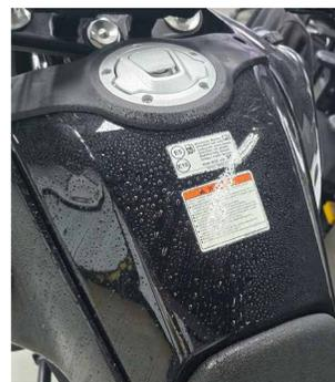
**4** Una vez esté correctamente posicionado el adhesivo, Humectar la superficie y usar el asentador FP a 90° para retirar la mezcla entre la superficie y el adhesivo, luego se podrá ir cambiando el ángulo de 90° a un ángulo inferior para facilitar el drenaje de la mezcla hasta que quede completamente adherido y sin burbujas a la superficie.
