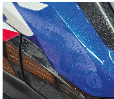
**4** Una vez este correctamente posicionado el adhesivo, Humectar la superficie y usar el asentador FP a 90° para retirar la mezcla entre la superficie y el adhesivo, luego se podrá ir cambiando el ángulo de 90° a un ángulo inferior para facilitar el drenaje de la mezcla hasta que quede completamente adherido y sin burbujas a la superficie.
