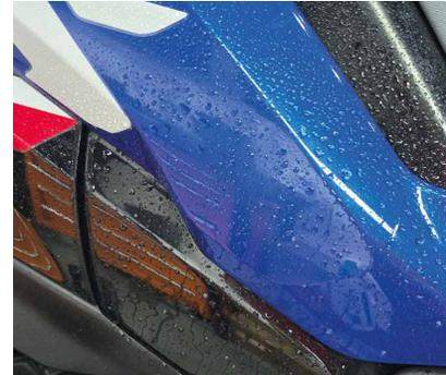
**4** Una vez esté correctamente posicionado el adhesivo, Humectar la superficie y usar el asentador FP a 90° para retirar la mezcla entre la superficie y el adhesivo, luego se podrá ir cambiando el ángulo de 90° a un ángulo inferior para facilitar el drenaje de la mezcla hasta que quede completamente adherido y sin burbujas a la superficie.
