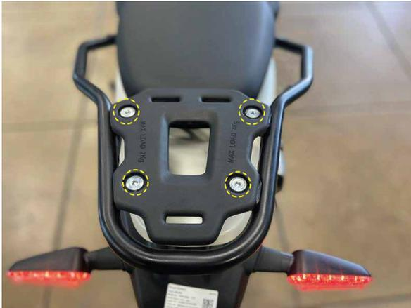
**2** Ensamble la PLA2 en los agujeros de la parrilla original de la motocicleta con los bujes y tornillos M6 como muestra la imagen (se puede ensamblar la parrilla con y sin la base plástica original).
