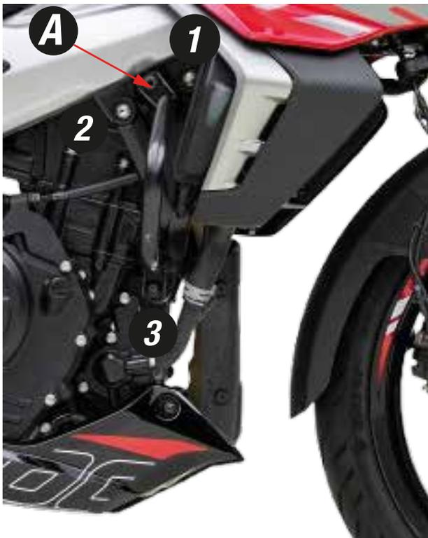
Retire los tornillos que sujetan el tubo en los puntos A y 3. Luego instale el slider del lado derecho según se muestra el diagrama teniendo en cuenta que se instala en los puntos 1 - 2 - 3.
