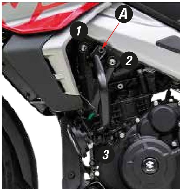
Retire los tornillos que sujetan el tubo en los puntos A y 3. Luego instale el slider del lado izquierdo según se muestra el diagrama teniendo en cuenta que se instala en los puntos 1 - 2 - 3.
