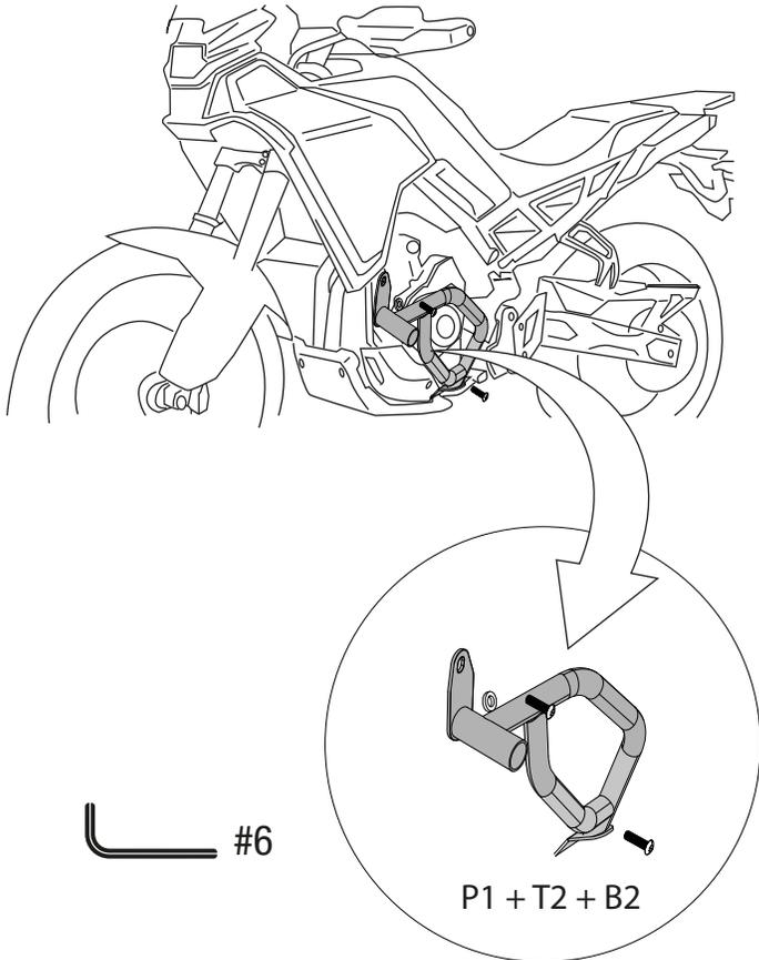
**3** Instalar en el lado derecho la defensa P2, el tornillo T2, el buje B2.
