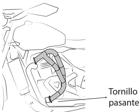
**5** Agregue la inyección (INY1), los tornillos socket M5x20 (T2) y las tuercas (TU1).
