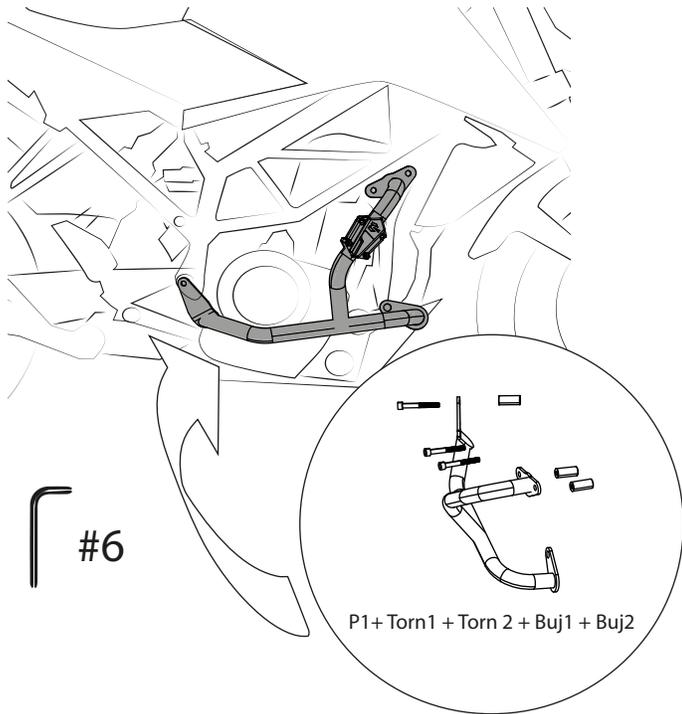
**3** En la platina frontal inferior (P1) instale el buje (Buj3) con el tornillo pasante de la moto.
