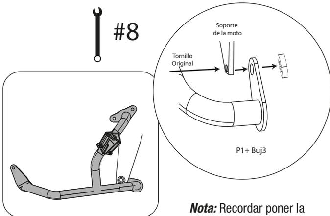
**Nota:** Recordar poner la platina central detras del soporte de la moto como se muestra en la ilustración
