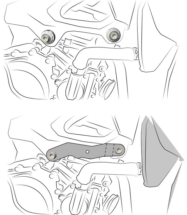
**6** Ensamble el punto de sujeción Inferior derecho P5 con los tornillos, T3, T1 y TCA2
