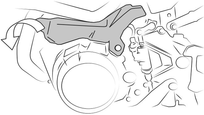
**3** Ensamble la sujeción inferior con los tornillos T2, B2, T4 y TCA 1
