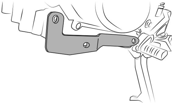
**4** Ensamble el lado izquierdo de la defensa en los puntos de sujeción previamente ensamblados. Use los tornillos T1 y tuercas TCA2
