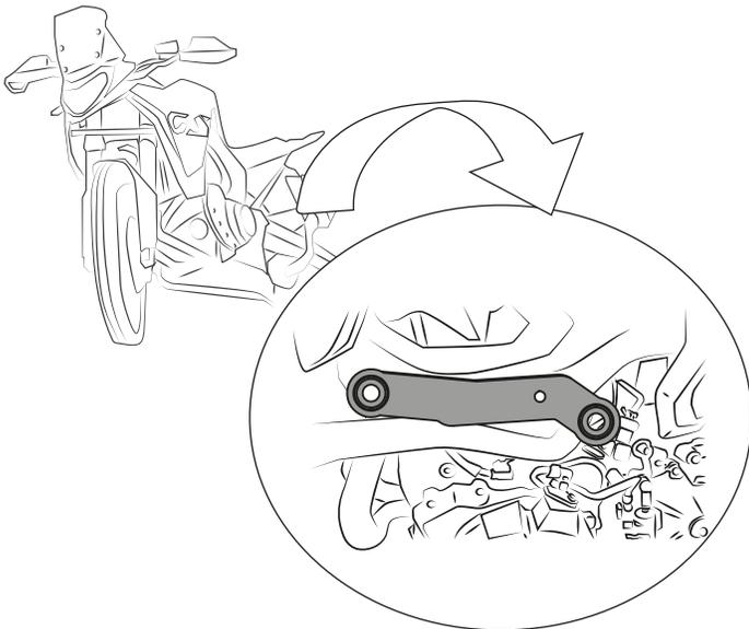
**5** Retire los tornillos que se indican en la imagen y ensamble la sujeción superior derecha P4 con los tornillos originales.
