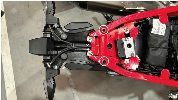
**3** En los dos puntos de sujeción ensamblar la platina de sujeción de la parrilla P4 con los tornillos T3.
