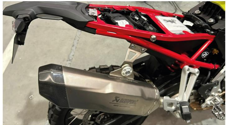
**2** Retire la tapa trasera y ubique los 2 puntos de sujeción.
