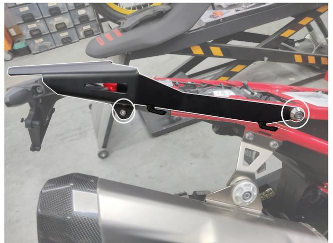
**6** Ensamble la platina lateral izquierda P3 con los tornillos T2, la tuerca de seguridad TCA1 y los tornillos originales de la moto como se indica en la imagen.
