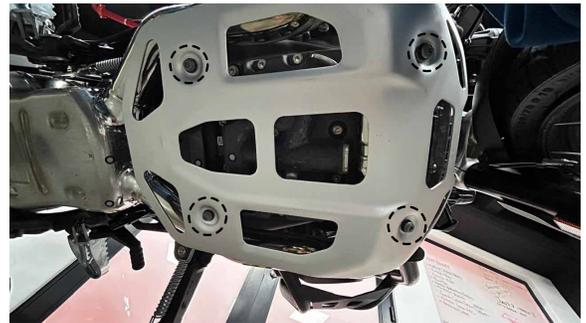
**2** Ensamble los bujes B1 en los cuatro puntos de sujeción.
