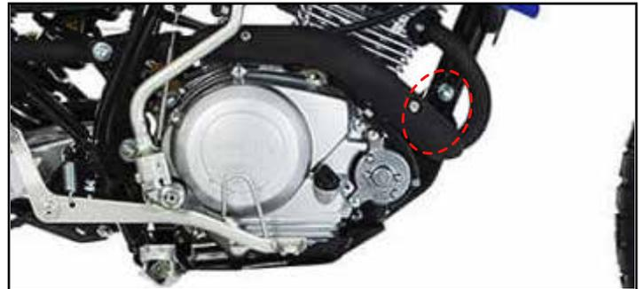
**2** Utilice la platina abrazadera para sujetar la parte superior de la defensa al chasis de la motocicleta.
