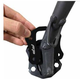
**2** Ensamble la base gato lateral según el esquema.
