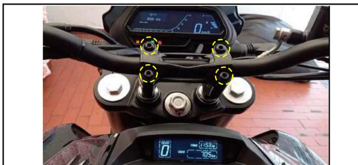
**2** Con el soporte previamente ensamblado a la platina (Ver diagrama) utilice los insumos (T2), (B1) para hacer el montaje en la moto.
