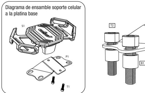
**3** Valide que el soporte este en paralelo con el tablero de la moto lo que garantiza la correcta visualización de la pantalla del telefono. Verifique el correcto angulo de instalación para que ajuste los tornillos y requinte.
