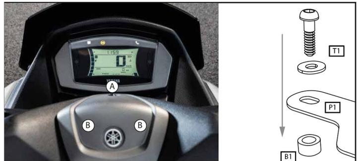
**3** Limpie el polvo o grasa de los puntos (B), retire la parte posterior de la cinta adhesiva instalada en la platina base. Ubique los puntos en el Manubrio (B) teniendo en cuenta la Instalación del Punto (A) e instale el soporte adheriendo las cintas y requintando el tornillo del punto (A).
