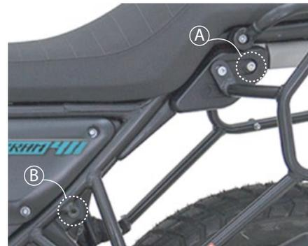
**2** Realice el montaje de los componentes según se Muestra en el **Esquema 1** utilizando los puntos de Anclaje A Y B .
