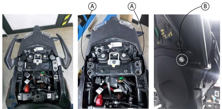
**2** Realice el montaje de los componentes utilizando los puntos de anclaje en la parrilla (A y B), con los puntos de sujeción (A y B) en la moto, como se muestra en el Esquema 1
