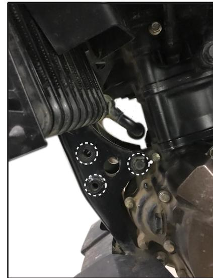
**2** Instale ambos sliders a cada lado simultáneamente, usando los insumos como indica el *esquema 1*.
