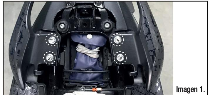
**2** Retire la tornillería original de la cola como se muestra en la *imagen 2* e instale la platina de sujeción con los tornillos M6 X 30 y los bujes según el *esquema 1*.
