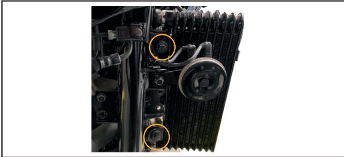
**6** Instale el protector de radiador como se indica en el siguiente diagrama
