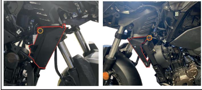
**5** Retire los dos tornillos que sujetan el radiador del chasis.
