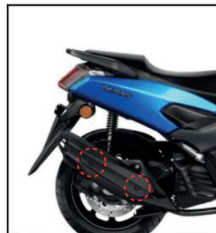
**2** Instale el slider de mofle de la marca **FIREPARTS** Utilizando la tornillería entregada según lo muestra el esquema
