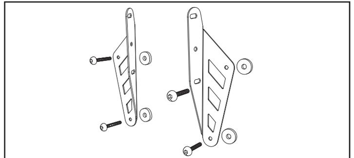
**3** Colocar las platinas superiores usando los tornillos y las tuercas M6 en la posición de tu preferencia como se muestra en el esquema, la posición 1 eleva la cúpula 11cms y la posición 2 eleva 6cms. En ambas posiciones se puedes ajustar el ángulo de la cúpula.
