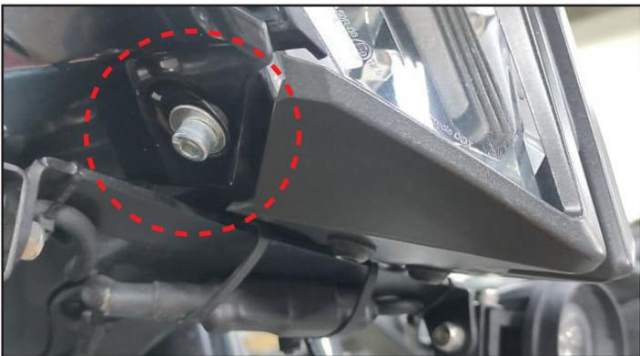
**2** Instale el protector de faro con la tornillería indicada en el esquema .
