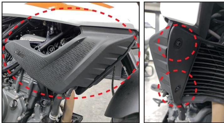
**2** Instalar la defensa en los tres puntos de sujeción indicados en la siguiente fotografía, con la tornillería especificada en el esquema; Repetir el proceso en los dos lados.
