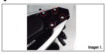
Utilice los puntos de sujecion indicados en la **Imagen 1** para realizar el montaje de los componentes segun se muestra en el **Esquema 1**.
