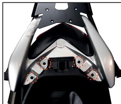
**2** Instale las puntas plasticas con la tornillería entregada según lo muestra el esquema, el slider debe ser instalado por debajo de la parrilla original de la Yamaha N-max
