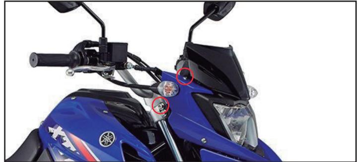
**2** Alinear la platina inferior con el punto marcado en el esquema usando la arandela entre el plástico y la platina. Luego ajustar con el tornillo respectivo.
