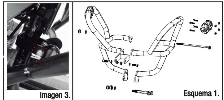
**3** Instalar el producto segun lo muestra el **Esquema 1,** producto completamente ensamblado en **Esquema 2.**
