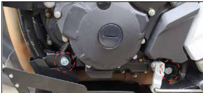
**4** Posicione la platina delantera del protector de carter por entre la platina original de la motocicleta e instale TORN1
