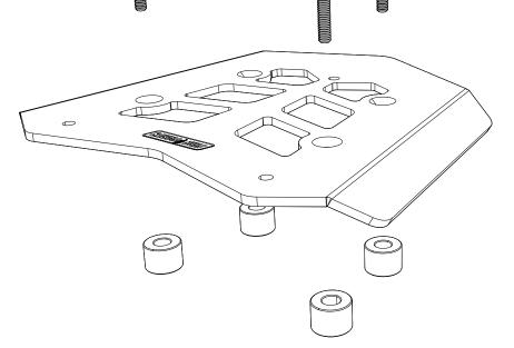
Al terminar la instalación de las partes, verifique que el Soporte esté alineado y que toda la tornillería esté debidamente apretada; reajuste todos los tornillos.
