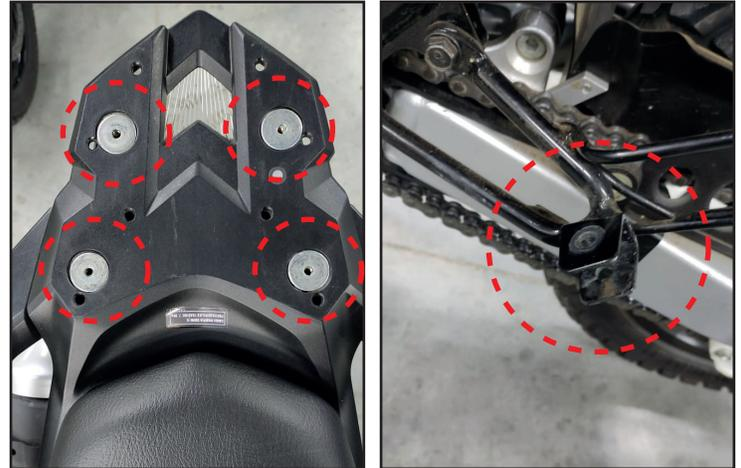
**2** Instale los soportes laterales y tubo trasero como lo indica el esquema.
