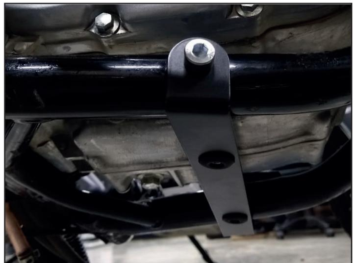
**3** Instale el protector de motor sobre las platinas de sujeción como lo indica el esquema.
