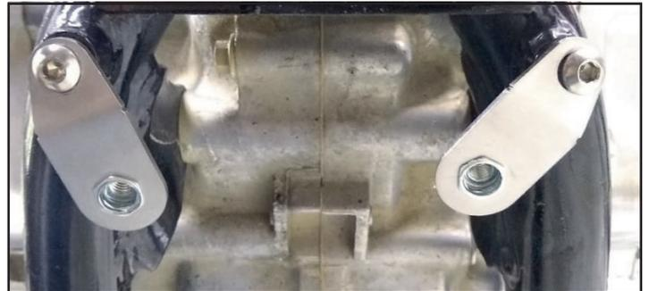
**2** Ubique la platina de sujeción inferior, en los puntos del chasis, como lo indica la siguiente fotografía.
