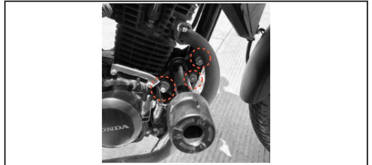
**2** Instale las puntas plasticas con la tornillería entregada según lo muestra el esquema
