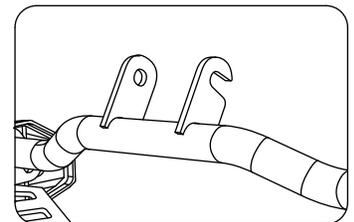
4. cuando el slider este sostenido en el punto superior, deje que slider alinee los puntos inferiores en los puntos de chasis tubular para ensamblar las Abrazaderas.
