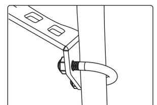
Al terminar la instalación de las partes, verifique que estén alineadas y que toda la tornillería esté debidamente apretada; reajuste todos los tornillos.
