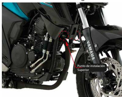
2. Para Instalar el slider, hay que reubicar la posición del pito. suelte el Pito para instalar el slider, hay que soltar el punto de la moto y también el punto del pito para reubicarlo con el Slider Instalado.
