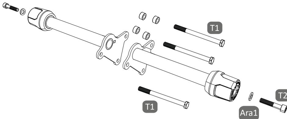
Al terminar la instalación de las partes, verifique que estén alineadas y que toda la tornillería esté debidamente apretada; reajuste todos los tornillos.
