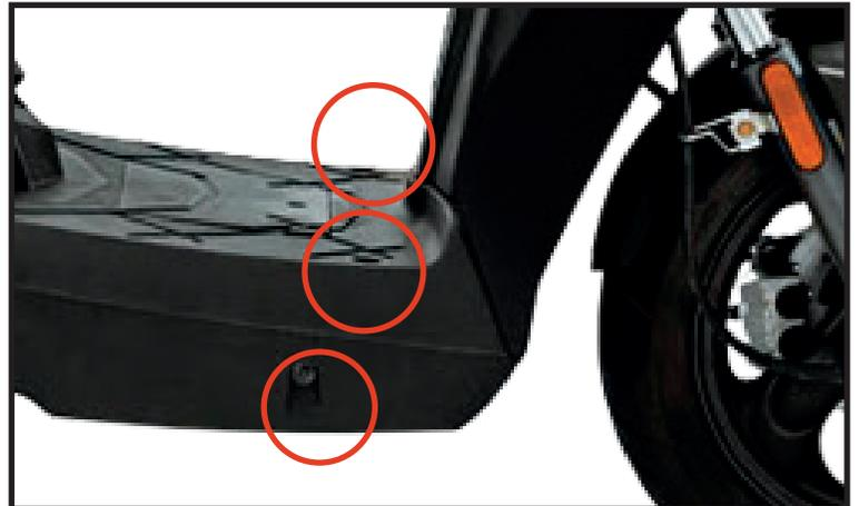
2 - Instale el slider delantero como lo indica el esquema.
