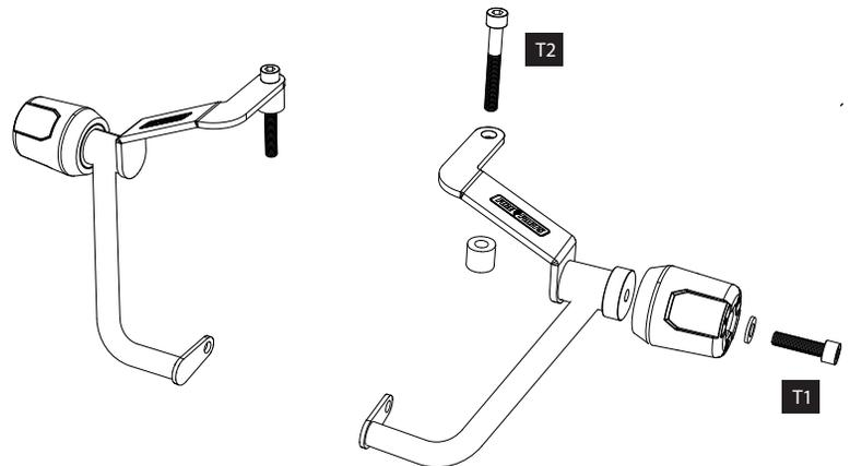
Al terminar la instalación de las partes, verifique que el protector de piso esté alineado y que toda la tornillería esté debidamente apretada; reajuste todos los tornillos.
