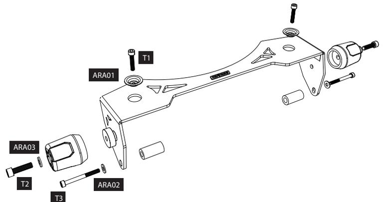
Al terminar la instalación de las partes, verifique que el protector de piso esté alineado y que toda la tornillería esté debidamente apretada; reajuste todos los tornillos.
