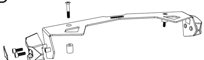
Al terminar la instalación de las partes, verifique que el protector de piso esté alineado y que toda la tornillería esté debidamente apretada; reajuste todos los tornillos.
