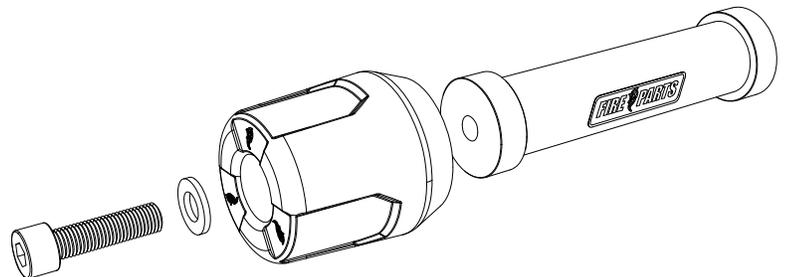
Al terminar la instalación de las partes, verifique que el protector de piso esté alineado y que toda la tornillería esté debidamente apretada; reajuste todos los tornillos.
