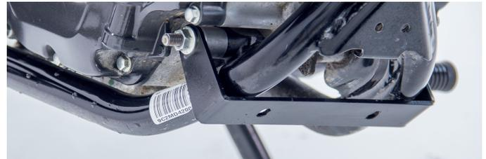
3. Sujete el protector de motor sobre la platina de sujeción
