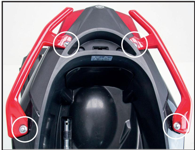
2 - Instale el soporte de maleta superior con la tornillería original y los bujes incluidos en el kit.
