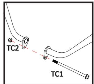
3- Instale la parte superior del slider utilizando la tornillería original de la motocicleta, como lo indica la siguiente imagen.
