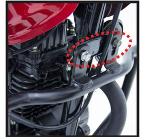
2- Instale la parte inferior del slider utilizando la tornillería TC1 y TC2 como lo indica la siguiente imagen y esquema.
